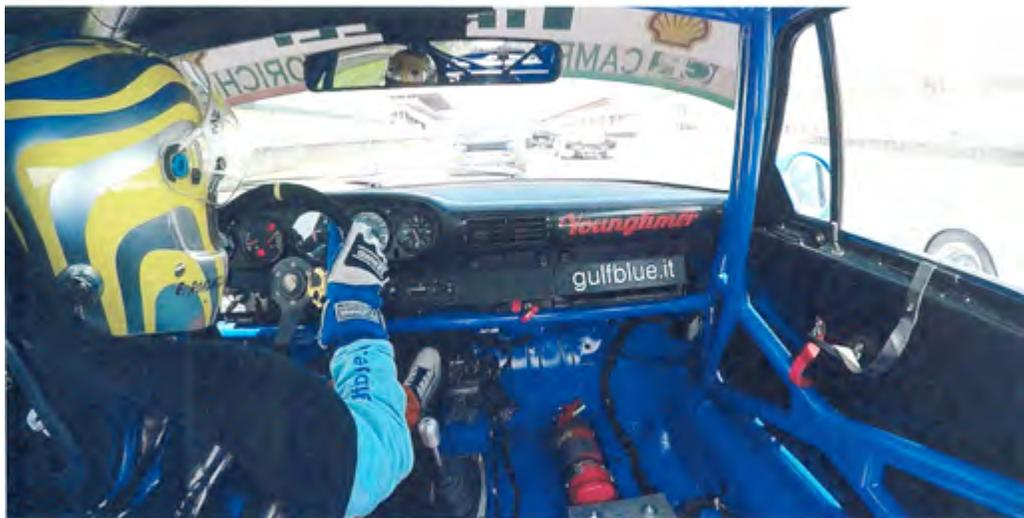
La vettura è svuotata di tutto ciò che non è necessario ma, per questioni regolamentari, non può pesare meno di 1180 kg: circa 80 kg più di quello che sarebbe il suo limite reale. La potenza del motore preparato, però è di 300 CV, contro i 250 del boxer di serie.
